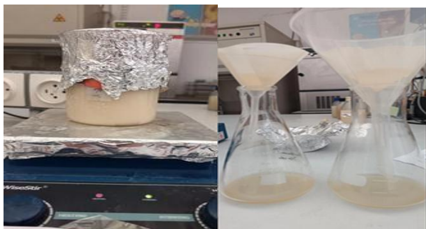
Figure 16: Agitation et filtration de la poudre végétale de l'extrait méthanolique.
