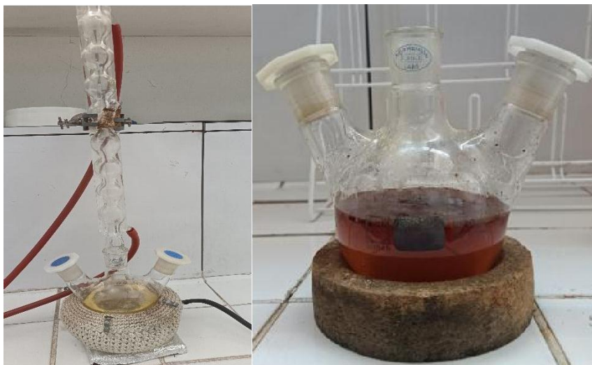
Figure 19: Montage et procédure d'extraction à reflux.
